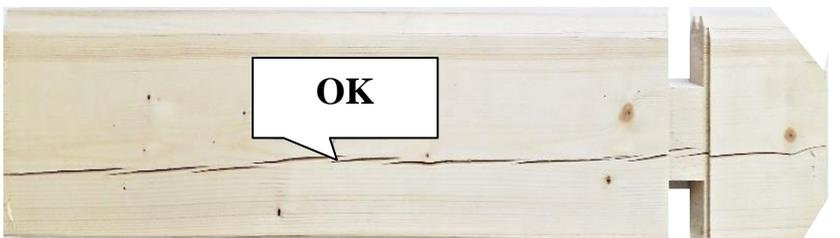
Nicht vollständig gehobelte Oberfläche: zulässig sind kleine Rauheit rund um die Äste, kaum bemerkbare Welligkeit auf der Oberfläche, kleine mechanischen Beschädigungen bis zu 20 mm der Kantenbreite und kleine mechanischen Beschädigungen an Enden, welche die Breite des Brettes nicht überschreiten. Zulässig sind außerdem nicht vollständig gehobelte Seitenflächen, wenn dadurch das Gesamtbild von zwei zusammengeführten Brettern nicht beeinträchtigt wird.
