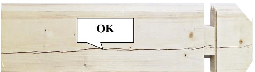
Nicht vollständig gehobelte Oberfläche: zulässig sind kleine Rauheit rund um die Äste, kaum bemerkbare Welligkeit auf der Oberfläche, kleine mechanischen Beschädigungen bis zu 20 mm der Kantenbreite und kleine mechanischen Beschädigungen an Enden, welche die Breite des Brettes nicht überschreiten. Zulässig sind außerdem nicht vollständig gehobelte Seitenflächen, wenn dadurch das Gesamtbild von zwei zusammengefügt Brettern nicht beeinträchtigt wird.
